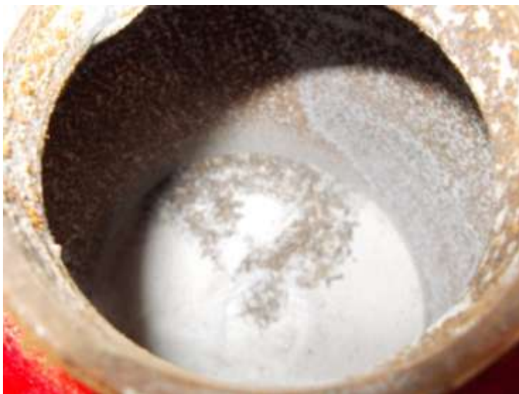
Bild 1: völlig verrosteter Metallbrandpulverlöscher, die letzte „Prüfung“ war genau zwei Jahre her!
