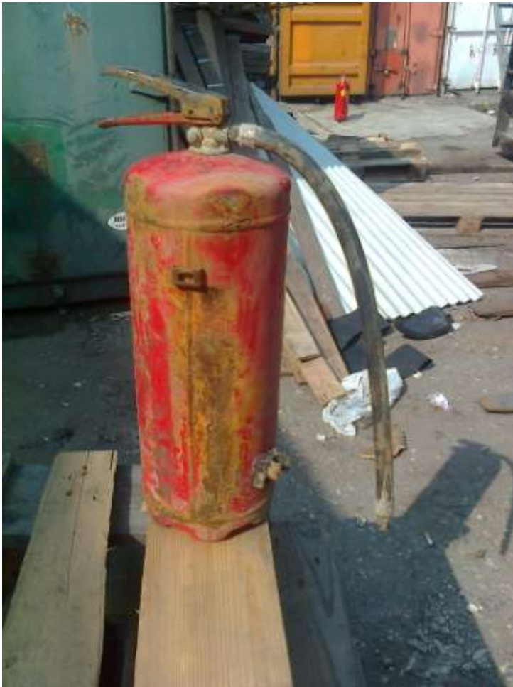
Bild 2: Dieser Feuerlöscher wurde mir in einem Transportbetrieb zur Prüfung übergeben!
